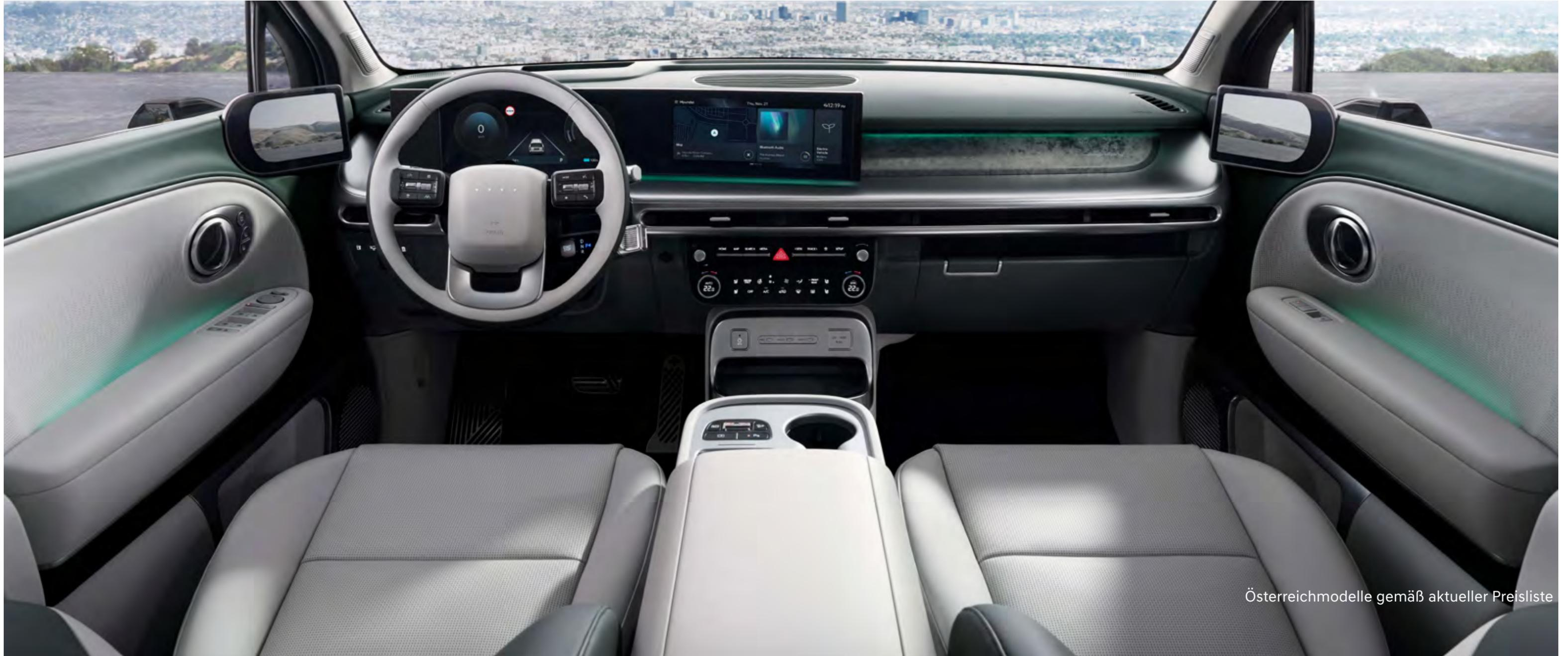
Das geschwungene Panoramadisplay des IONIQ 9 beherbergt eine digitale 12-Zoll Armatur und ein 12-Zoll Infotainment-System. Das Lederlenkrad verfügt ausstattungsabhängig über interaktive LED-Pixel, die von der Begrüßung im Fahrzeug, über die Anzeige des gewählten Fahrmodus bis hin zur Signalisierung des Status, verschiedener Fahrzeugsysteme übernehmen.
